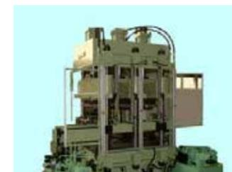
500KN×3ST トランスファープレス装置
