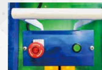
フット SW 上部に非常停止ボタンとラム上昇ボタンを設置 不意の危険を防ぎ安全作業を確保します。
