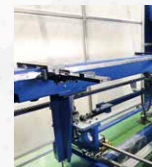
機械後部からの侵入を防ぎます。後部扉が開いた状態での機械動作は不可となります。
